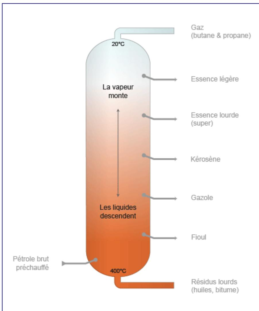
Principe de fonctionnement d'une tour de distillation de pétrole brut (©Connaissance des Énergies)
