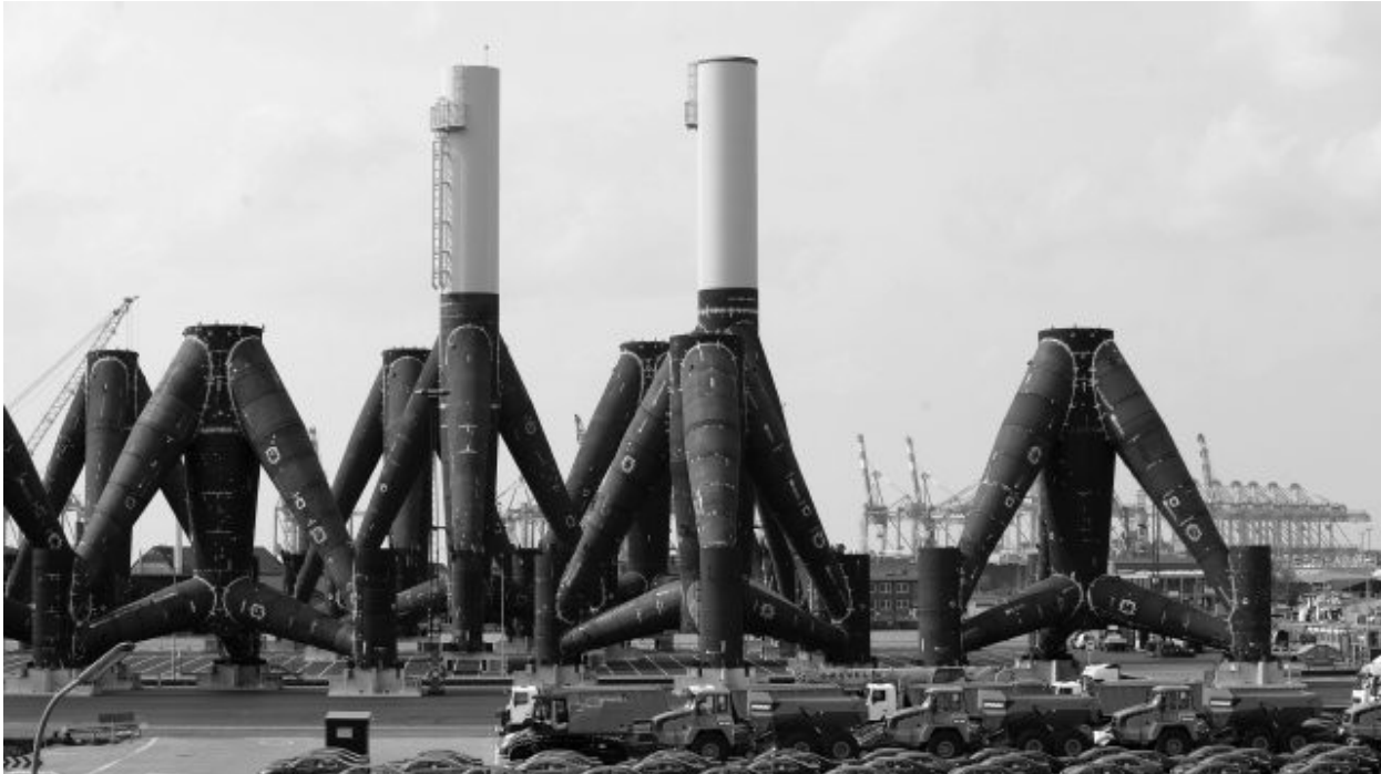
Pieds d'éoliennes de mer prêts à être livrés depuis Bremerhaven (Allemagne). Le secteur belge de la mer du Nord pourrait accueillir 4,4 GW d'éolien offshore, souligne la Coalition Climat. ©BELGAIMAGE
